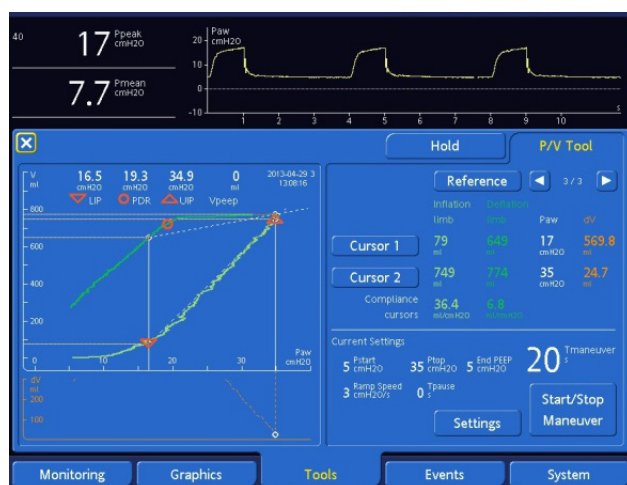
Рис. 1. Функция курсора позволяет выполнять графический анализ кривой, в частности определять точки перегиба.
